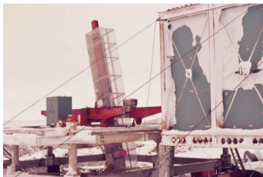
写真 4 S-160JA の打上げ（組立調整室の下にハーマンネルソン熱風送風機が見える）
