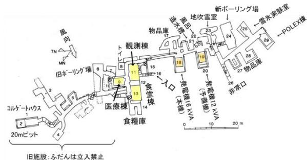
図1 みずほ基地の配置図。全て雪面下にある。
