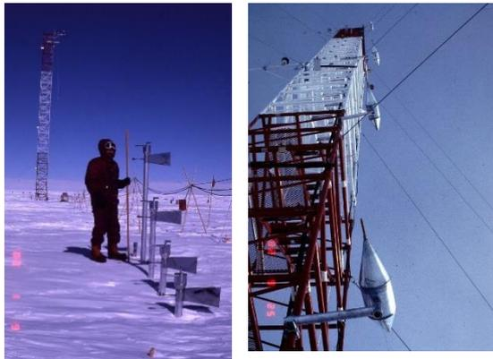
写真5 雪面のサイクロン型地吹雪計(左)と30mタワーのロケット型地吹雪計(右)
